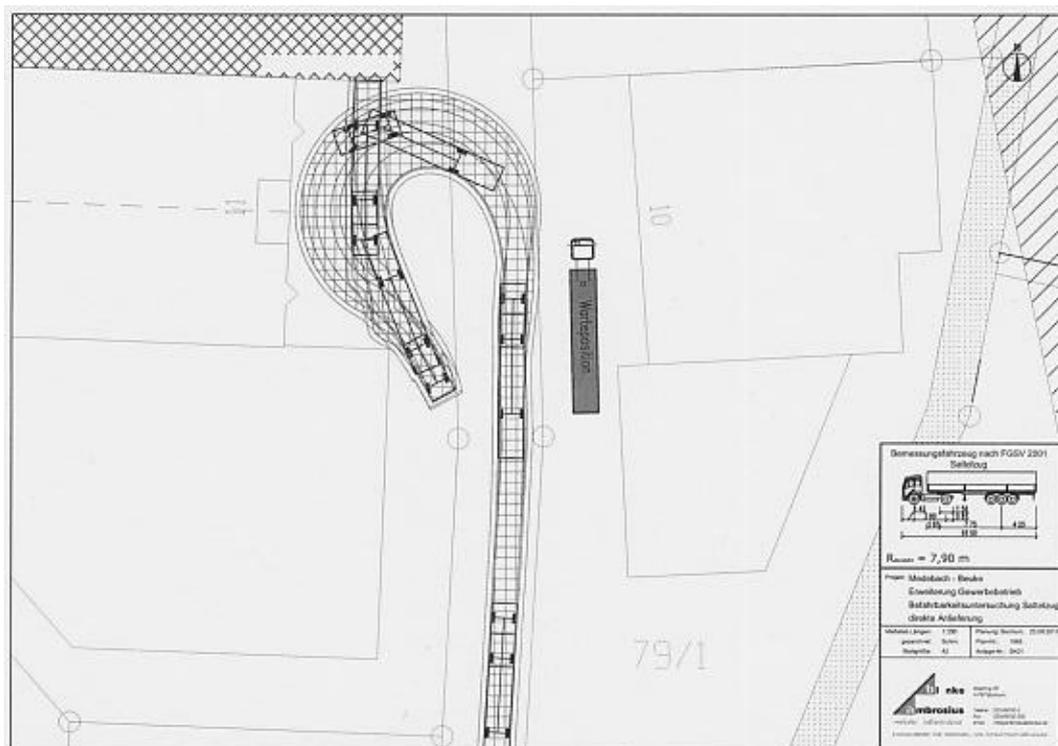
Abb XX - Befahrbarkeitsuntersuchung ‚Sattelzug‘ in direkter Anlieferung
