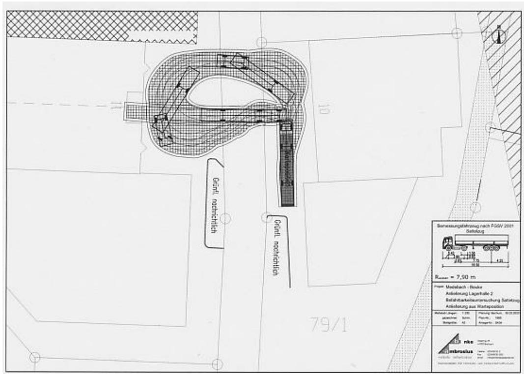
Abb. xxx - Befahrbarkeitsuntersuchung Anlieferung mit ‚Sattelzug‘ aus der Warteposition
