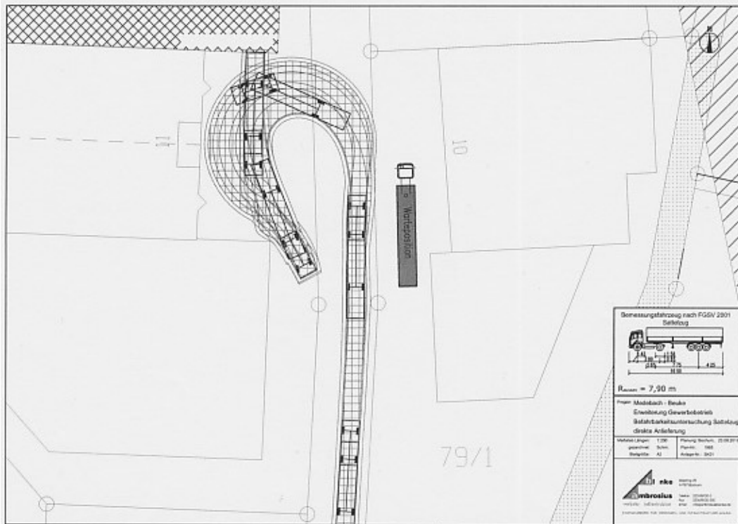
Abb 62 - Befahrbarkeitsuntersuchung ‚Sattelzug‘ in direkter Anlieferung
